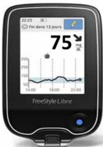
Figure 1 : Un lecteur du glucose en continu qui affiche la glycémie avec une flèche de tendance (↘) indiquant une baisse rapide en cours.
